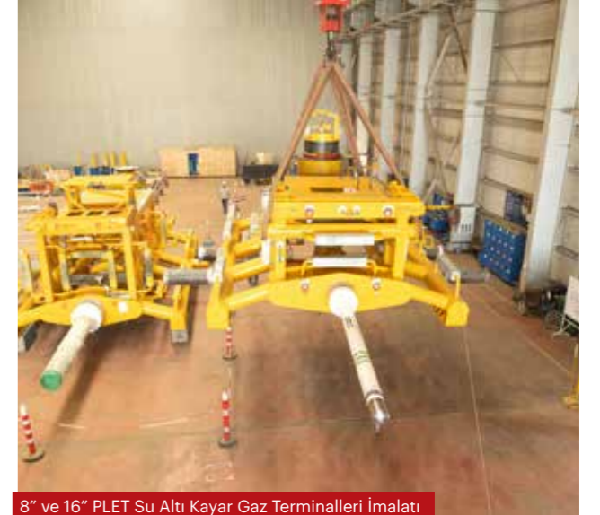
8" ve 16" PLET Su Altı Kayar Gaz Terminalleri İmalatı
