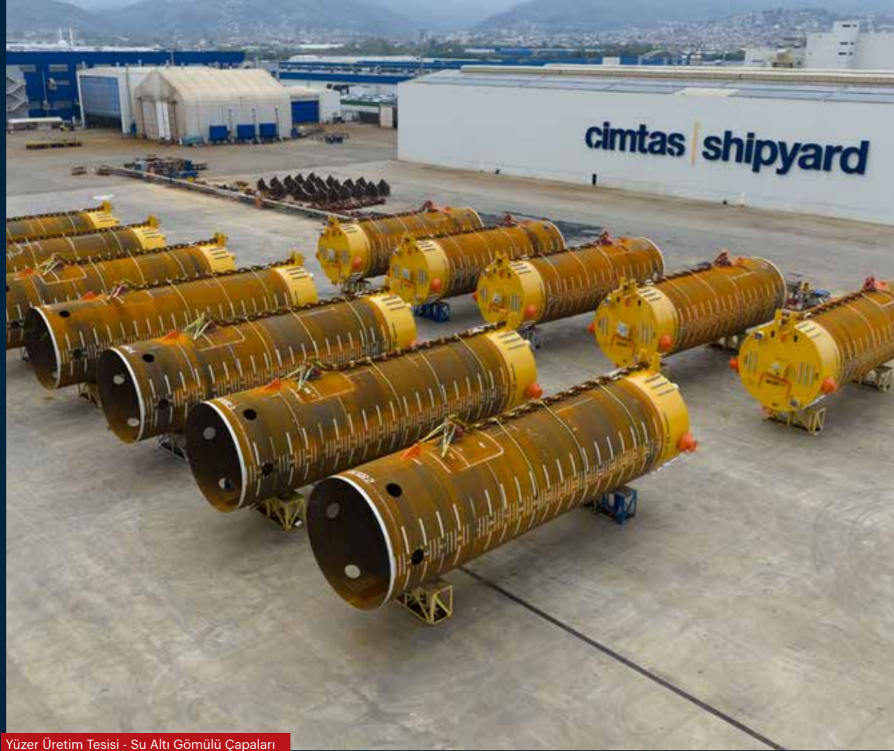
Yüzer Üretim Tesisi - Su Altı Gömülü Çapaları
