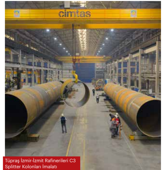
Tüpraş İzmir-İzmit Rafinerileri C3 Splitter Kolonları Gövde İmalatı
