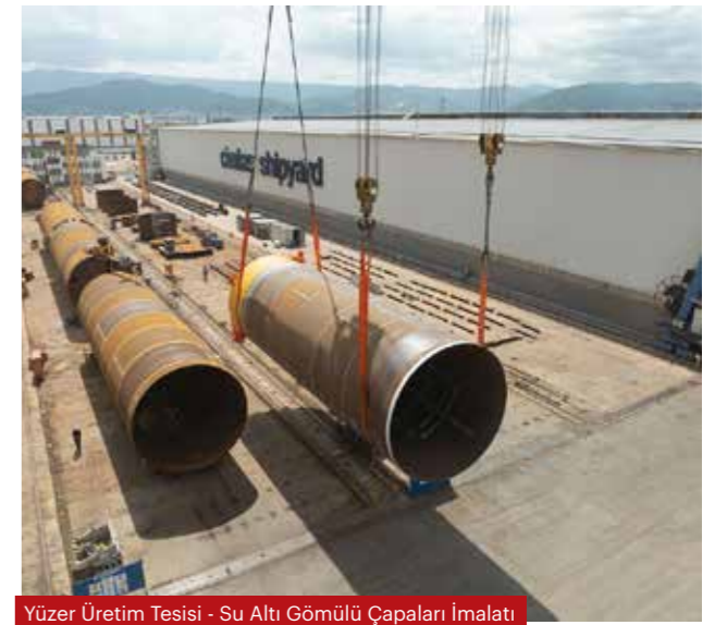
Yüzer Üretim Tesisi - Su Altı Gömülü Çapaları İmalatı
